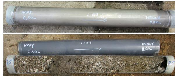
oben: Edelstahlliner für Laborversuch (gasdicht verschlossen)
